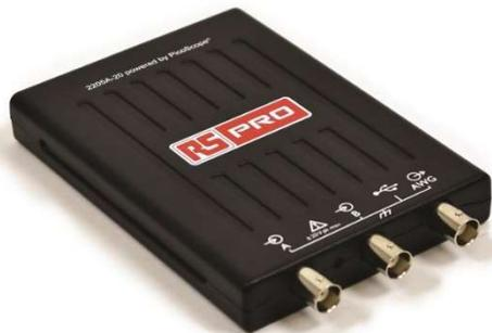
L'eccellente integrità del segnale, con un rumore RMS inferiore a 150 microvolt e una distorsione armonica di  $-50$  dB, lo rende adatto per numerose applicazioni analogiche e digitali. La sorgente di segnale integrata può fungere da generatore di segnale standard (per le funzioni seno, quadrato,
